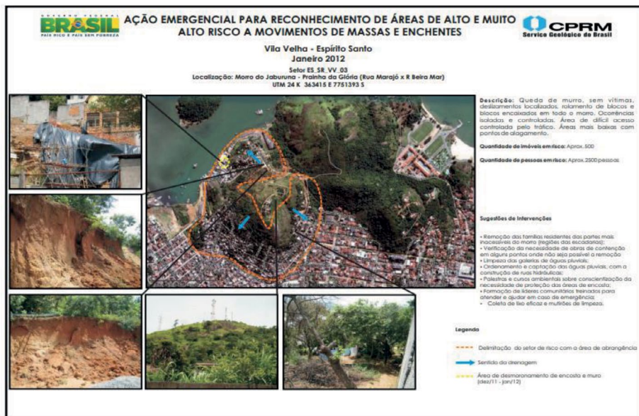
Figura 5 – Mapa de ação emergencial para reconhecimento de áreas de alto e muito alto risco a movimentos de massas e enchentes – Morro do Jaburuna, Vila Velha-ES
